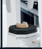
Особый протокол позволяет выполнять томографию радиографических шаблонов, протезов, моделей или слепков, разместив их на специальной подставке.
