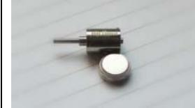
Открутите кнопку с помощью ключа и вытащите картридж. Установите новый картридж в углубление головки и нажмите на него. Закрутите кнопку руками, затем затяните ключом.
