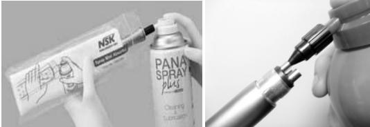
Смазка производится любым многофункциональным смазочным спреем для стоматологических наконечников.
