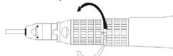
Извлечение бора: поверните кольцо против часовой стрелки до упора, извлеките бор.
