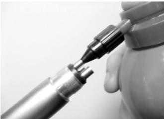
Смазка производится любым многофункциональным смазочным спреем для стоматологических наконечников.
