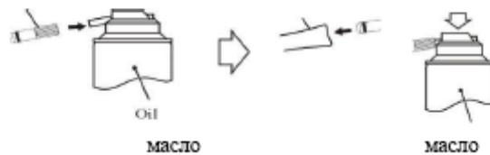
Смазка производится любым многофункциональным смазочным спреем для стоматологических наконечников.
