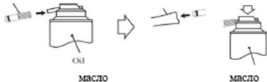
Смазка производится любым многофункциональным смазочным спреем для стоматологических наконечников. Смазывайте наконечник в течение 1-2 секунд перед каждой стерилизацией в автоклаве. Процедура смазки: Встряхните баллон 3-5 раз. Затем вставьте насадку в наконечник до упора и распыляйте спрей в течение 1-2 секунд.
