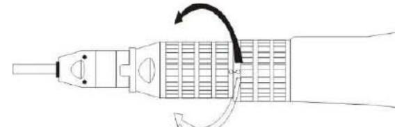
Извлечение бора: поверните кольцо против часовой стрелки до упора, извлеките бор.
