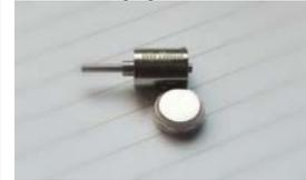
Открутите кнопку с помощью ключа и вытащите картридж. Установите новый картридж в углубление головки и нажмите на него. Закрутите кнопку руками, затем затяните ключом.
